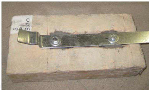
Figure 23 e 24- L'aggancio fissato con resina VoRpa dopo il test a carico protratto fino al collasso che ha interessato la parete terminale ad U ma non gli agganci al cotto.
