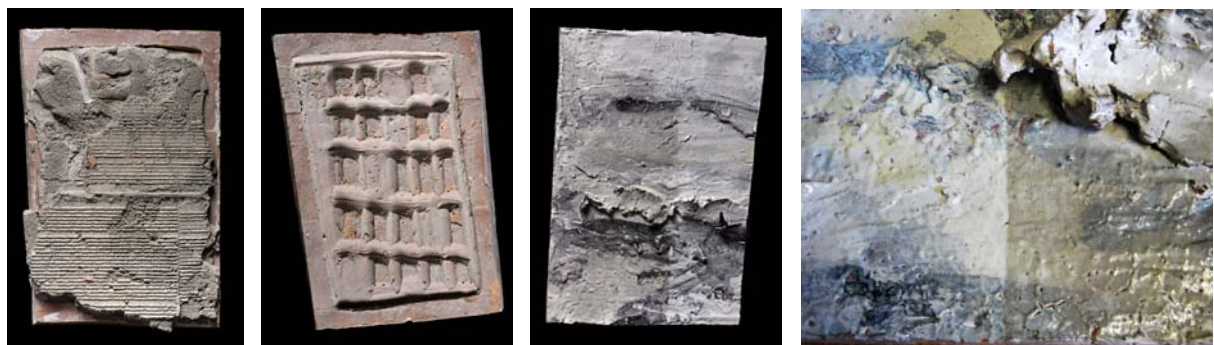
Figure da 11 a 14- Esempio di pulitura di una formella avvenuto in due fasi: rimozione meccanica della malta cementizia che ricopriva la parte tergale, pulitura della superficie smaltata con tamponi imbevuti di acqua demineralizzata e tensioattivo.
