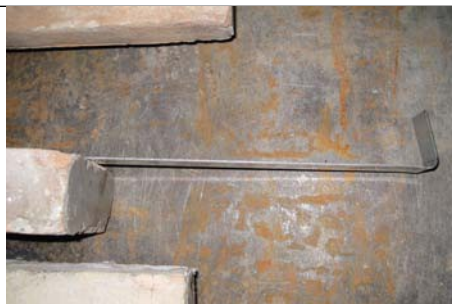
Figure 23 e 24- L'aggancio fissato con resina VoRpa dopo il test a carico protratto fino al collasso che ha interessato la parete terminale ad U ma non gli agganci al cotto.
