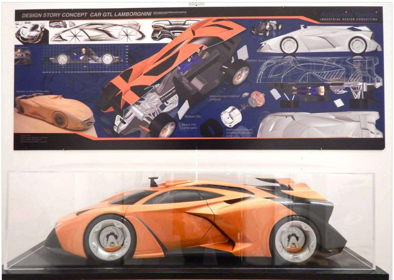
Concept Car GTL LAMBORGHINI, modello di stile in scala 1:5, realizzato in poliuretano e resina.
