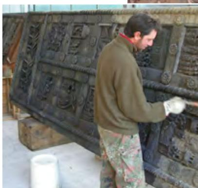
Si passa poi alla formatura e allo stampo in negativo: sul modello originale viene steso uno strato di gomma che una volta seccata viene rinforzata con un guscio di gesso. Questo involucro di gesso e gomma è detto "forma". La gomma è il negativo dell'opera.
